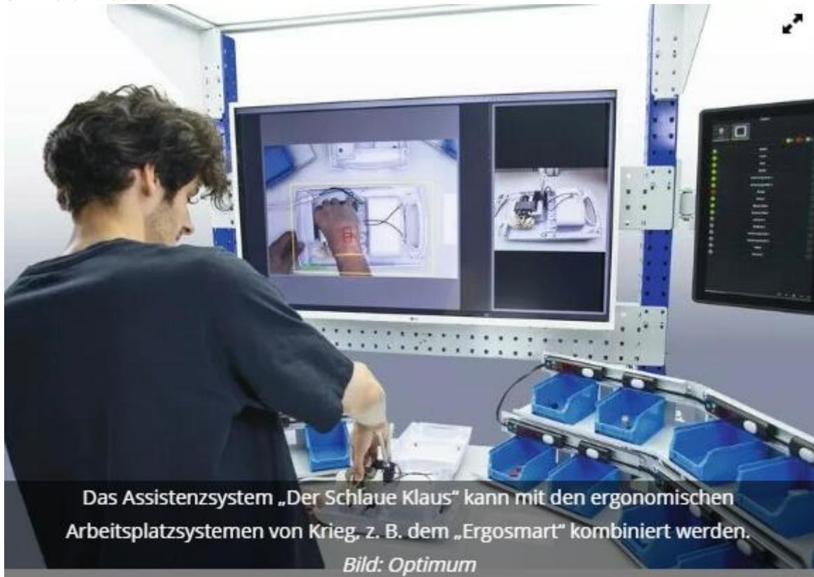
**Ein kognitives und kamerabasiertes Assistenzsystem zeigt, wie die Symbiose von Mensch und Maschine gelingen kann. „Der Schlaue Klaus“ unterstützt manuelle Arbeitsprozesse z. B. im Wareneingang, der Kommissionierung oder der Montage. In Kombination mit einem ergonomischen Arbeitsplatz werden so Produktivität, Effizienz und Flexibilität erhöht.**
