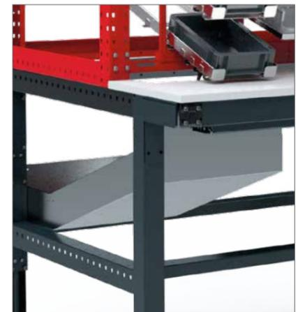
Über eine unter dem Tisch integrierte Leerbehälter-Rückführung kann der Mitarbeiter die anfallenden Leerbehälter ideal und ohne Zeitverlust abführen. Die leeren Behälter können dann von hinten durch die Logistik wieder abgeholt werden.
