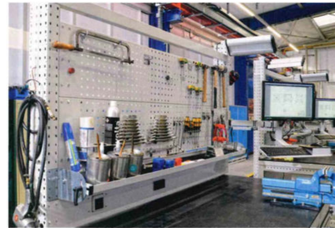
Schnelle Montage und Umrüstung, werkzeuglos steckbare Zubehör-Komponenten und Funktionalität dank voller Raumnutzung sind positive Aspekte des Werkbanksystems.
