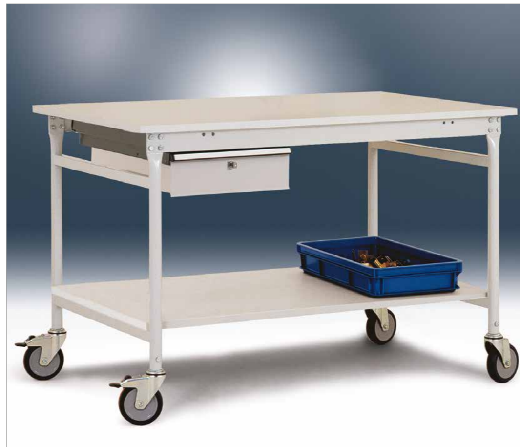
Beistelltische BASIS mobil mit 4 Lenkrollen, davon 2 feststellbar, Gesamthöhe 850 mm. Tisch und Gehäuse einfarbig. Tragkraft max. 250 kg.
