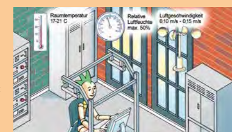
Direktblendung durch zu große Helligkeitsunterschiede im Blickfeld z.B. Fenster
