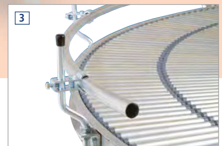
3 Seitenführungen aus Stahlrohr 25 mm Ø verzinkt. Stufenlos höhenverstellbar von 50-130 mm. Breite stufenlos verstellbar von Bahn-Nutbreite -140 bis +24 mm.
