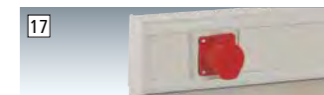
CEE-Steckdose 1PE (über Haupt-Schalter 3PE) 400 V, 16A 4+1pol./6h inkl. Einbaudose und Blende 80 mm.
