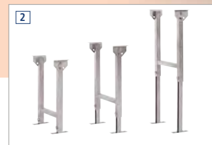
2 Doppelgelenk-Rahmenständer wird zur Einhaltung der Bahnen-Tragkräfte alle 1500 mm oder für Kugel-Rollentisch benötigt. Aus Stahl verzinkt. Stufenlos höhenverstellbar von 650-1020 mm. Tragkraft 200 kg.
