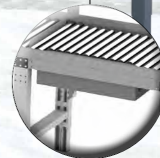
Waage in der Rollenbahn integriert
