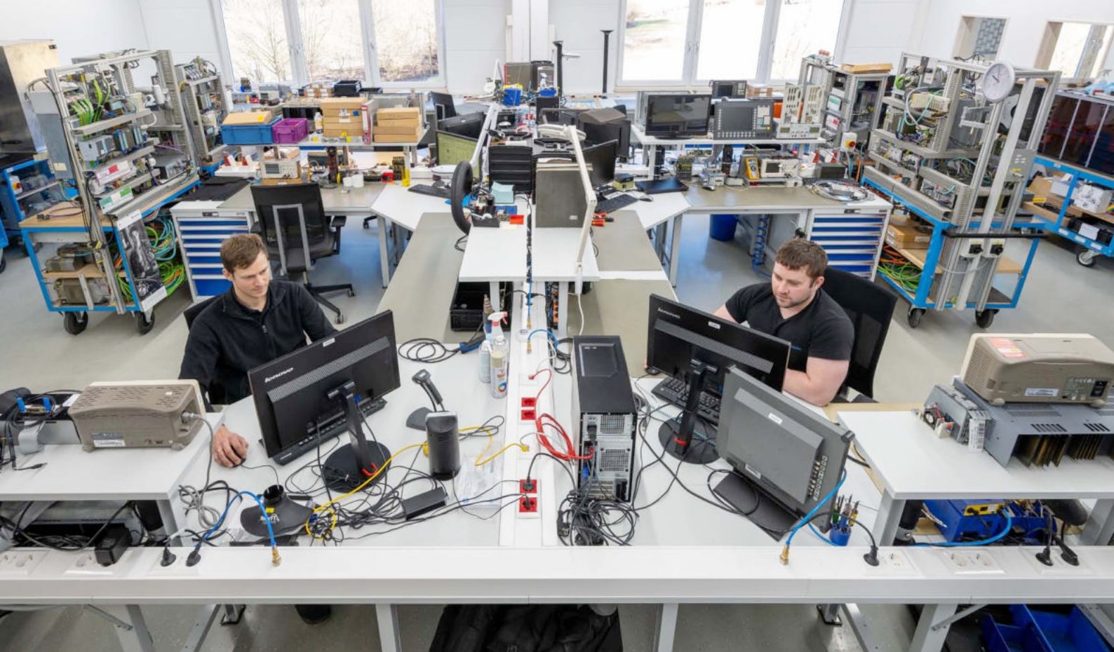
Die Montagearbeitsplätze bei Allmendinger bieten vollständigen ESD-Schutz in Form der Electro-Static-Discharge-Ausstattung. Bilder: Krieg
