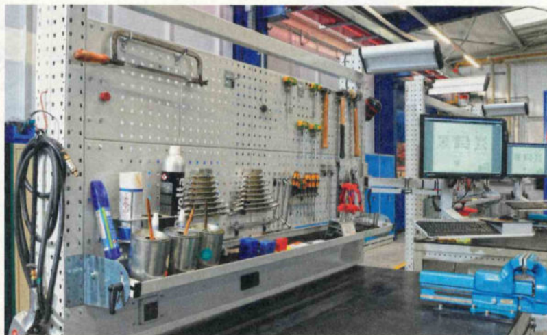
Eingerichtet wurden neben vier großflächigen Profiplan-Werkbänken auch für jeden Mitarbeiter entsprechende Schränke, Zusatztische, Werkzeugleisten, Druckluftzuleitung und Ablageflächen.
